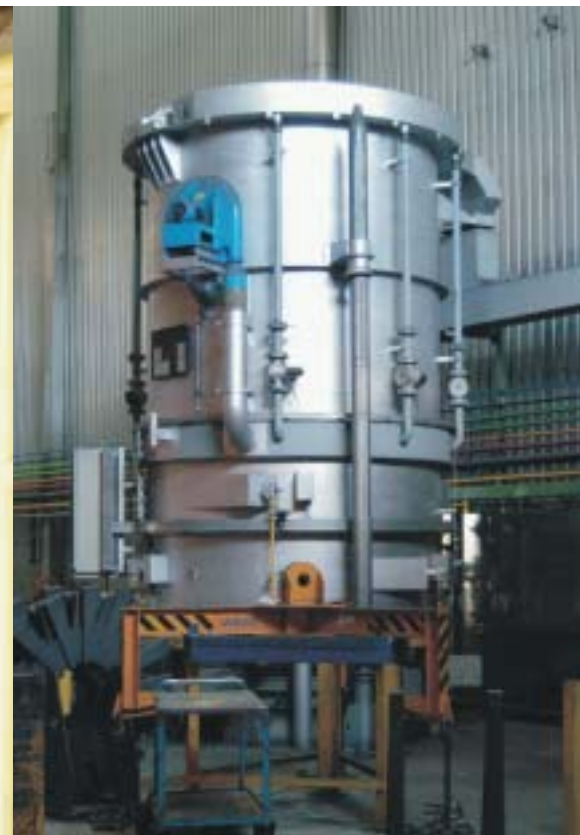
Für Schutzgasglühungen stehen moderne Wasserstoff-Hochkonvektions-Haubenöfen zur Verfügung. Modern hydrogen high-convection hood-type furnaces are available for annealing under protective gas.
